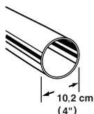
2. Utilice una capota de ventilación de 10,2 cm. Capotas más pequeñas aumentan el tiempo de secado.
