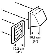
3. El ducto de escape puede ser dirigido hacia arriba, hacia abajo, a la izquierda, derecha y directamente hacia atrás por la parte posterior de la secadora. Los requerimientos de espacio están listados en sus Instrucciones de Instalación.
