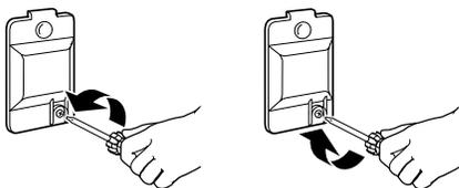
3. Gire el foco en sentido contrario a las manecillas del reloj. Reemplácelo únicamente con un foco para electrodomésticos de 10 W. Vuelva a colocar la cubierta en su lugar.
