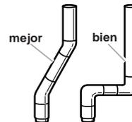
5. Utilice cinta para ductos para sellar todas las uniones. No use tornillos para detener el ducto de escape. A los tornillos se les puede adherir pelusa.
